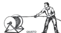
Dev'essere effettuato montando la bobina su un'asse orizzontale sostenuta da due cavalletti all'estremità. E' errato avvolgere la fune tenendo la bobina fissa appoggiata a terra su una delle due fiancate.
